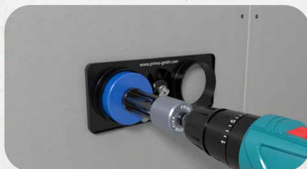
3. Per combinazioni multiple, inserire la dima di foratura (P102-74) nel primo foro. Allineare utilizzando la livella integrata e stringere la leva. Riposizionando la dima è possibile praticare un numero di fori aggiuntivi a piacere alla distanza standard di 71 mm.
