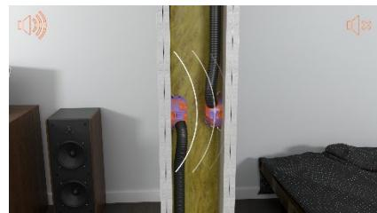
Für Schallschutzwände (100 mm Wandstärke) bis 58 dB, auch bei gegenüberliegendem Einbau der Dosen.
