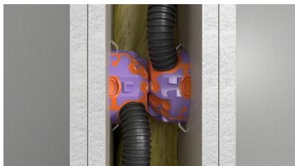
Perfekt geeignet für den Einsatz in engen Wandaufbauten.
