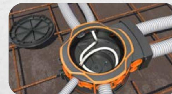
6. Der abnehmbare Deckel ermöglicht es, Kabel und Leitungen bereits vor der Betonage ins Einbaugehäuse einzuziehen. Dank der integrierten Membrandichtlippe bleibt alles absolut betondicht.
