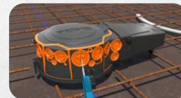
4. Membran mit Cuttermesser öffnen. Kabel und (starre) Rohre wie gewünscht ohne zusätzliches Werkzeug einführen. Das System bleibt dank der Membrantechnik absolut betondicht. Die Kombieinführungen bieten Platz für Rohre und Kabel der Größen M9 bis M40.
