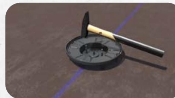
1. Einbaugehäuse mithilfe der integrierten Markierung am Frontteil positionsgenau an der Schalung ausrichten. Einfache und schnelle Montage durch die integrierte Nagelfixierung. Wurde die Armierung bereits eingebracht, hilft der Primo Nagler für eine einfache und verletzungsfreie Befestigung.
