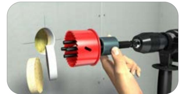
Aluminiumhülse fest halten und Bohrkern durch Linkslauf der Bohrmaschine auswerfen lassen.
