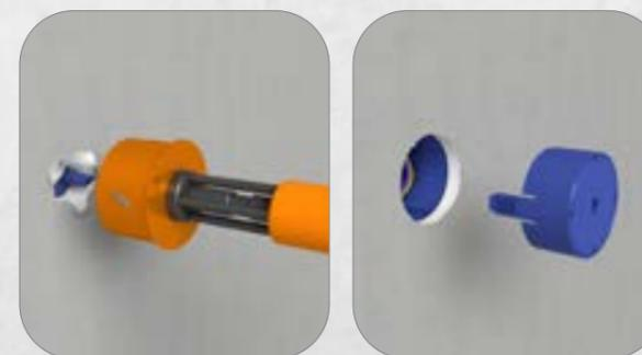
3. Loch ausfräsen. Der Dorn dient dabei als Zentrierbohrloch. Bohrdeckel entfernen. Dosenoberteil aufstecken und bündig mit der Gipskartonplatte eindrücken.
