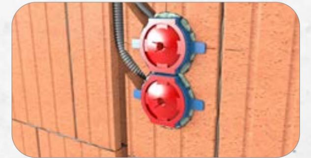
8. Den nach außen gewölbten Putzdeckel zum Schutz der Schraubdomen, des Doseninneren und zur Reduktion des Putzauftrages auf die Öffnung der Dose aufsetzen.
