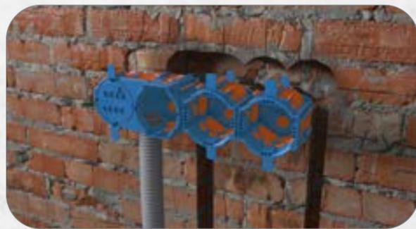
1. Die Membranrastzähne fixieren die Dosen sicher im Loch. Das ermöglicht die zeitsparende Montage bereits verrohrter Dosen.
