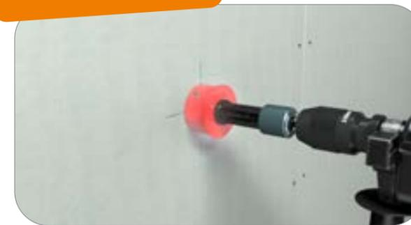
Bohrkrone aufschrauben. Wenn benötigt zuvor Randversenker (seperat erhältlich) einsetzen. Patentierte Aufnahme für Lochsagen ab 38 mm.
