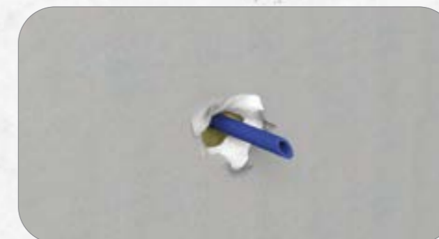
2. Angeschrägten Dorn durch zweite Gipskartonplatte drücken, ggf. vorher mit Hammer Loch einschlagen.
