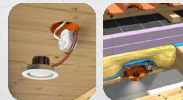
3. Einbauleuchte oder andere Einbaugeräte von unten anschließen und in die 68 mm Einbauöffnung stecken. Fertig! Einbaugehäuse und Uni-Flexx schützen die Isolierung im Sichtdachstuhl. Damit sind die Energieeffizienz und der Brandschutz weiter gegeben.
