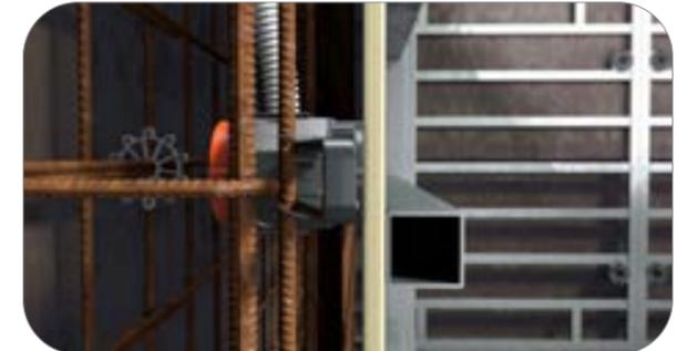
Für unterschiedliche Betondeckungen kann die Betondose um 180 Grad gedreht werden. Flügel mit Draht an der Stahlarmierung befestigen. Flexible Flügel passen sich der jeweiligen Betondeckung an.
