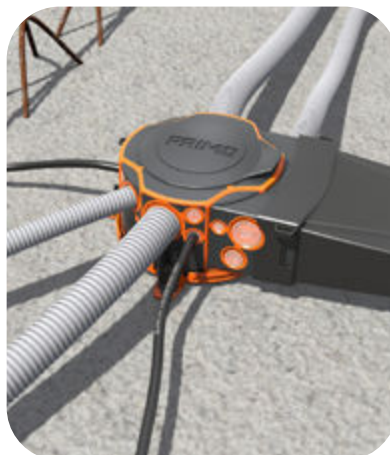
Membran mit Cuttermesser öffnen und Rohre/Kabel absolut betondicht und sicher zugent- lastet einführen.
