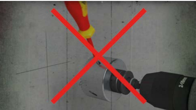
Herkömmliches und zeitaufwändiges Entfernen des Bohrkerns.
