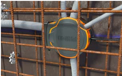
Membrane mit einem Cuttermesser öffnen. Werkzeuglose Kombi-Einführung von Kabeln und (starren) Rohren von M9-M40. Die Membrantechnik gewährt eine absolut betondichte Einführung.
